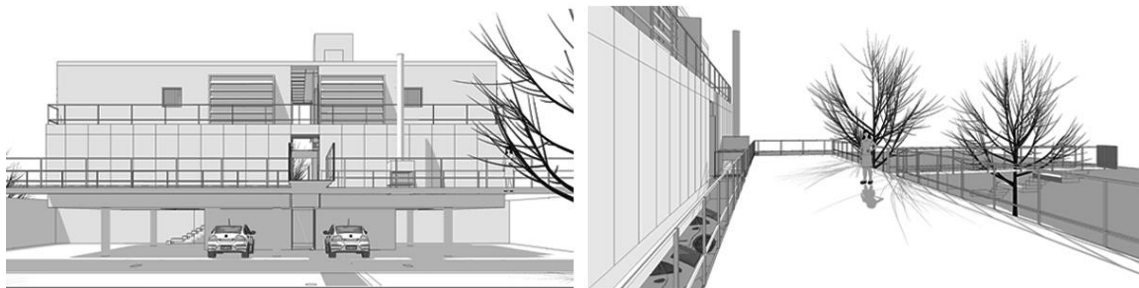
Figura 8: Volumetria prismática sobre pilotis e laje-terraço na Casa PA, 2003. São Paulo – SP. Metro Arquitetos Associados e Paulo Mendes da Rocha. Fonte: SAMURIO, 2015.
