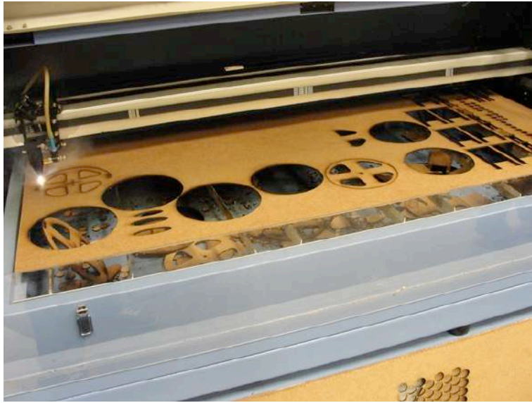
Figura 11. Corte das peças para o mecanismo de movimento do modelo físico na máquina de corte a laser . Fonte: autores, 2011.
