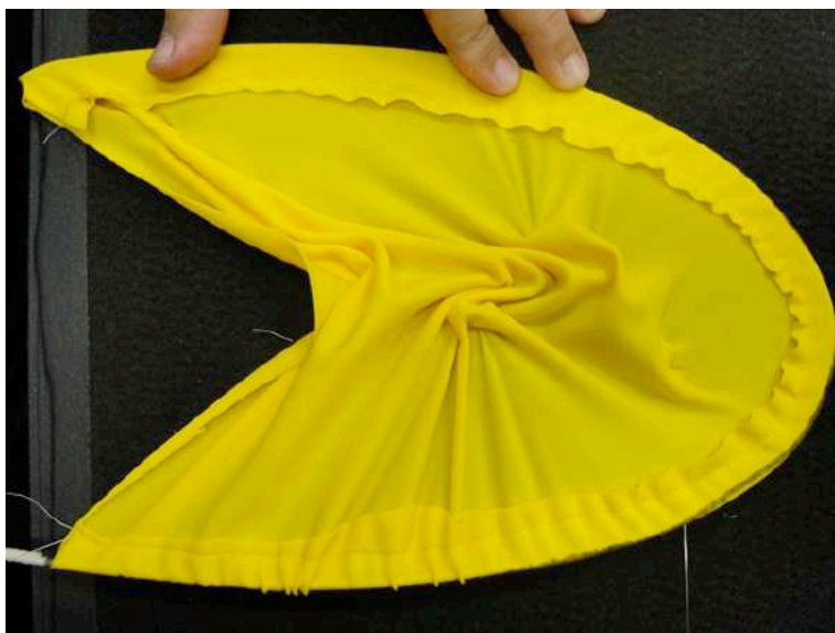
Figura 5. Reação do elastano frente aos esforços impostos pela tensão e pelo padrão de costura.
