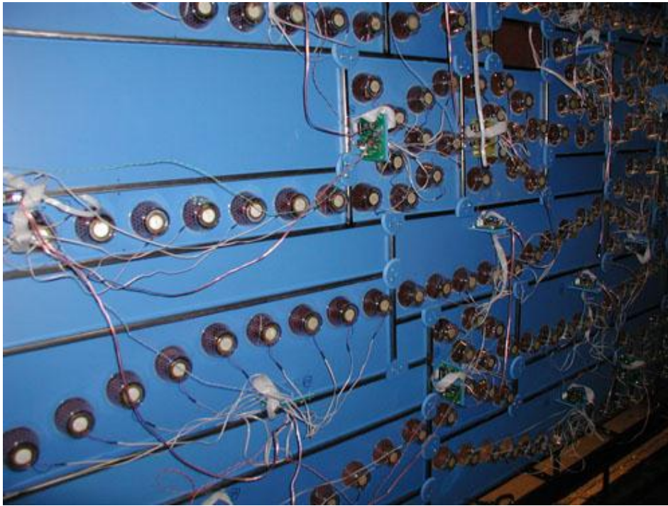
Figura 06: rede de sensores e de alto-falantes . Fonte: banco de dados Transition Soundings, < http://ame2.asu.edu/faculty/dab/transitionsoundings.php >.
