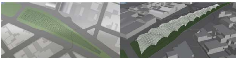
Fig. 8: Código 01 programado no Grasshopper : Define a cobertura e estrutura do pavilhão principal. Fonte: acervo da pesquisa, 2018.
