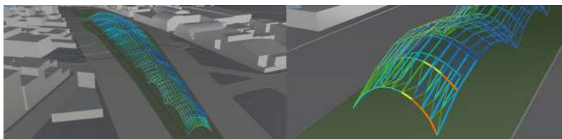
Fig. 10: Detalhe da treliça com o dimensionamento das seções dos perfis vinculado à análise de tensão. Visualização no Rhinceros 3D . Fonte: acervo da pesquisa, 2018.
