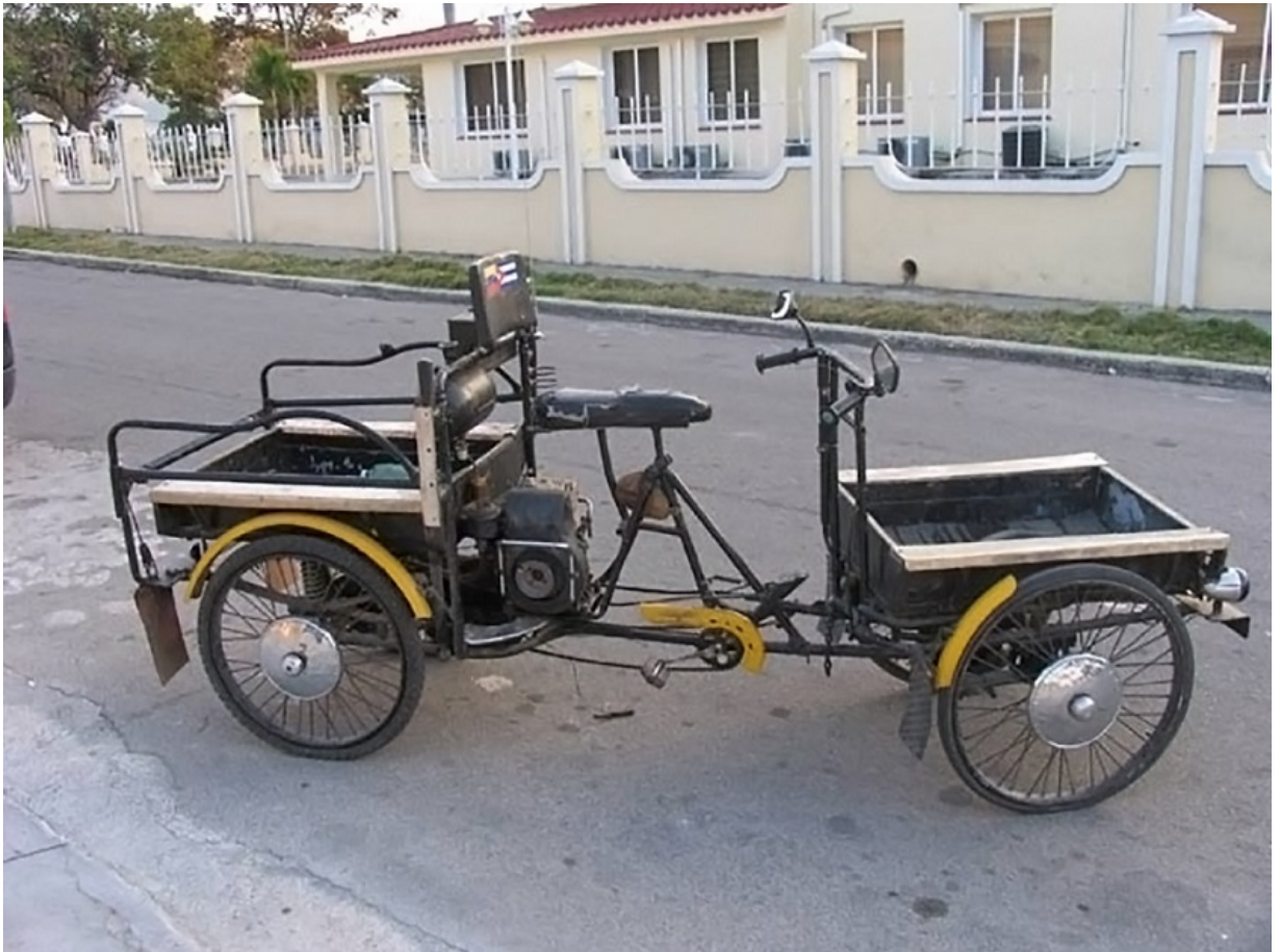
Fig. 7: Rikimbili, bicicleta motorizada cubana. Fonte: OROZA, 2005. Disponível em: http://www.ernestooroza.com/rikimbili/ . Acesso em: 23 Out. 2021
